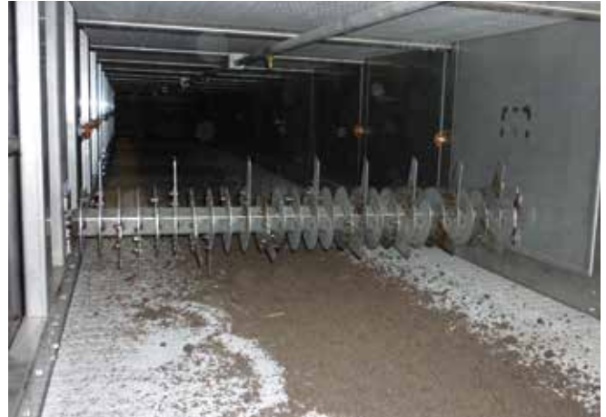
Dikke fractie digestaat op de transportband in de vergistingsinstallatie.
